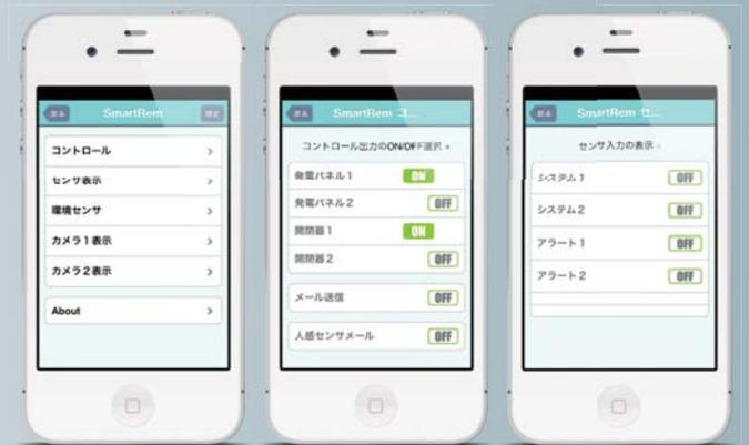
SmartRem IoTは、Webサーバー内蔵のスタンドアロンで動作するBox。入力6点、出力6点、RS485をサポートします。メールクライアント、DDNSアップデートをサポートし、専用のアスセスドメイン、メールアドレスも付いています。
